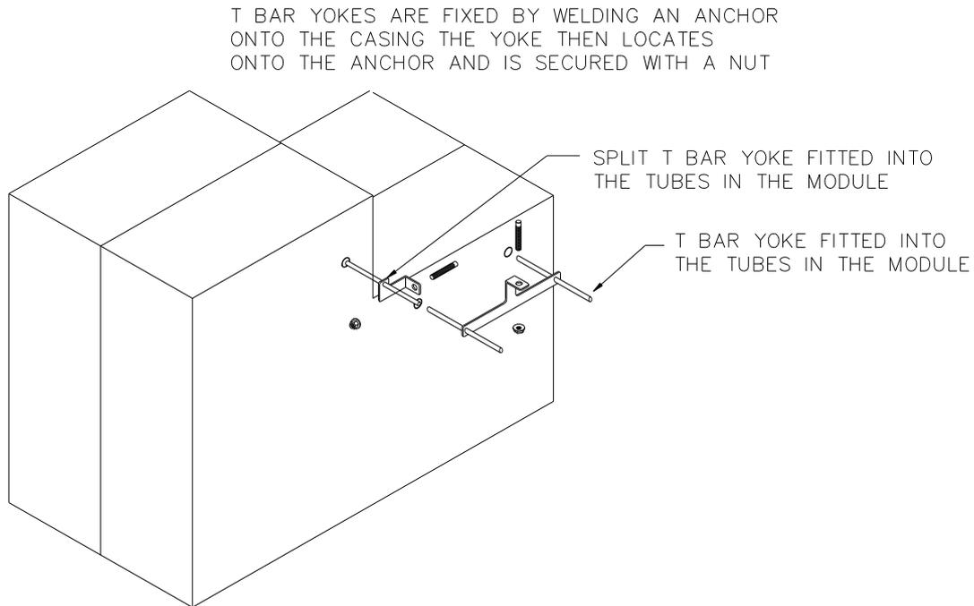
**Figure 4 - Pyro-Bloc Corner Module**
